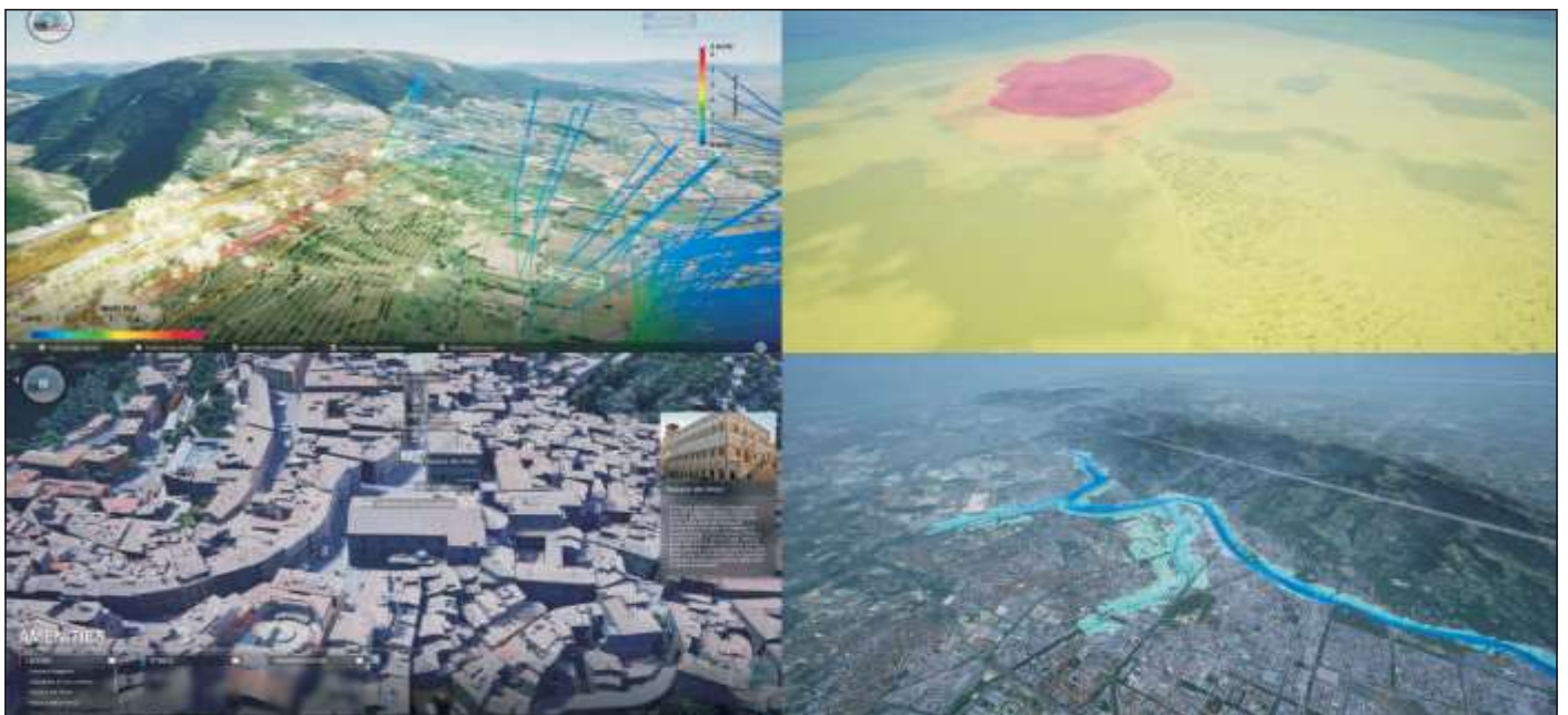
05 - Digital Twin Ambientale con Dati GIS e Simulazioni Fluidodinamiche (Vento sulla zona Aeroporto Assisi) e del Rischio Contaminazione e Inondazione tramite l'utilizzo di Piattaforme integrate in tempo reale con dati Geografici e di Monitoraggio
