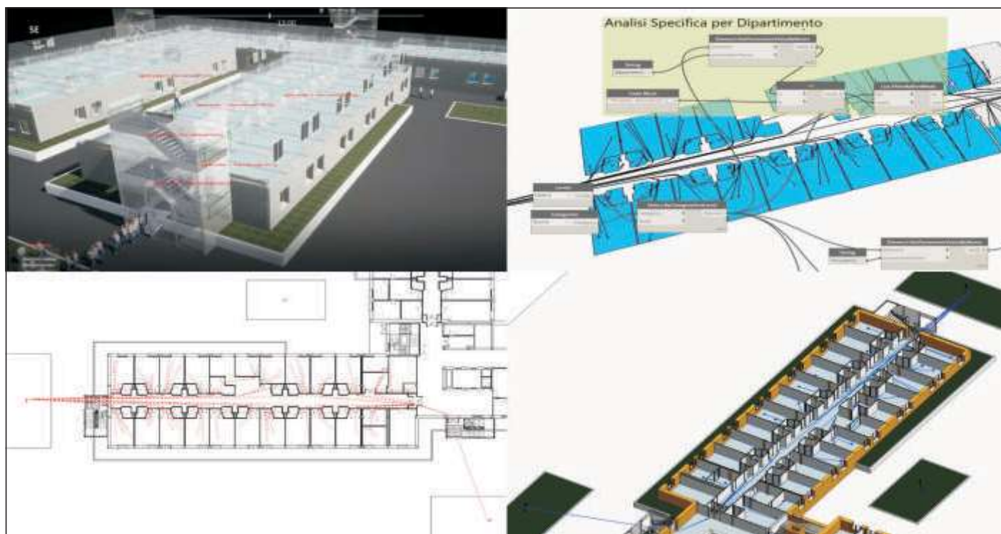
02 - Integrazione di Routine di Intelligenza Artificiale e Programmazione in Ambito BIM Con API Specifiche, simulazione con Agenti AI per processi di Evacuazione Ospedaliera con Casi Limite e Rapporti sui carichi delle Strutture in Tempo Reale e raffigurazione in specifiche Dashboard Riassuntive.
