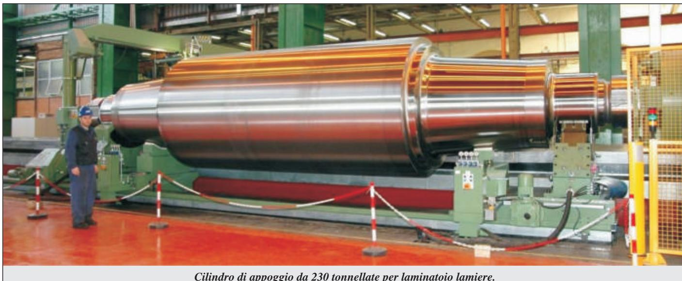
Cilindro di appoggio da 230 tonnellate per laminatoio lamiere.
