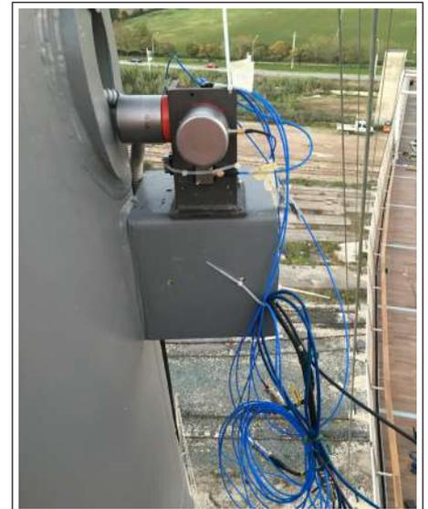
Fig. 3 - Accelerometri su uno dei piloni del tripode.
