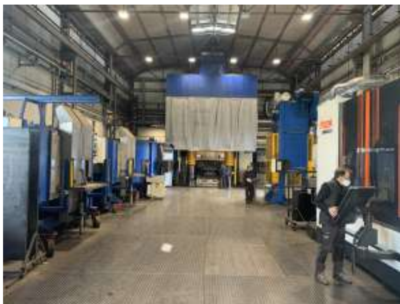
Il reparto di forgiatura in cui viene utilizzata anche una Pressa da 5.000 tonnellate.
