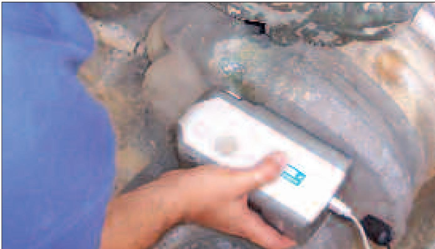
*Spettrocolorimetria sulla fontana delle Tartarughe - Piazza Mattei (Roma): Analisi fisica non distruttiva, utile per la determinazione colorimetrica della superficie prima del trattamento di pulitura e caratterizzazione delle diverse zone cromatiche.*
