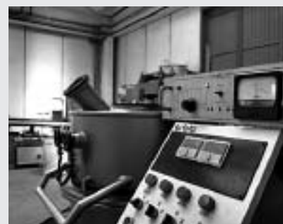
Campana per il vuoto diametro utile interno: 600 mm Valore del vuoto che si raggiunge: circa 10-6 atm
